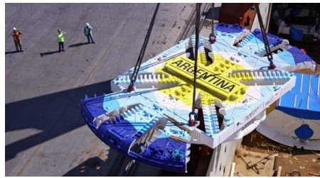
Imagen N°4: Máquina tuneladora, una TBM (Tunnel Boring Machine) importada desde Alemania (Fuente: http://www.transporte.gov.ar ).
